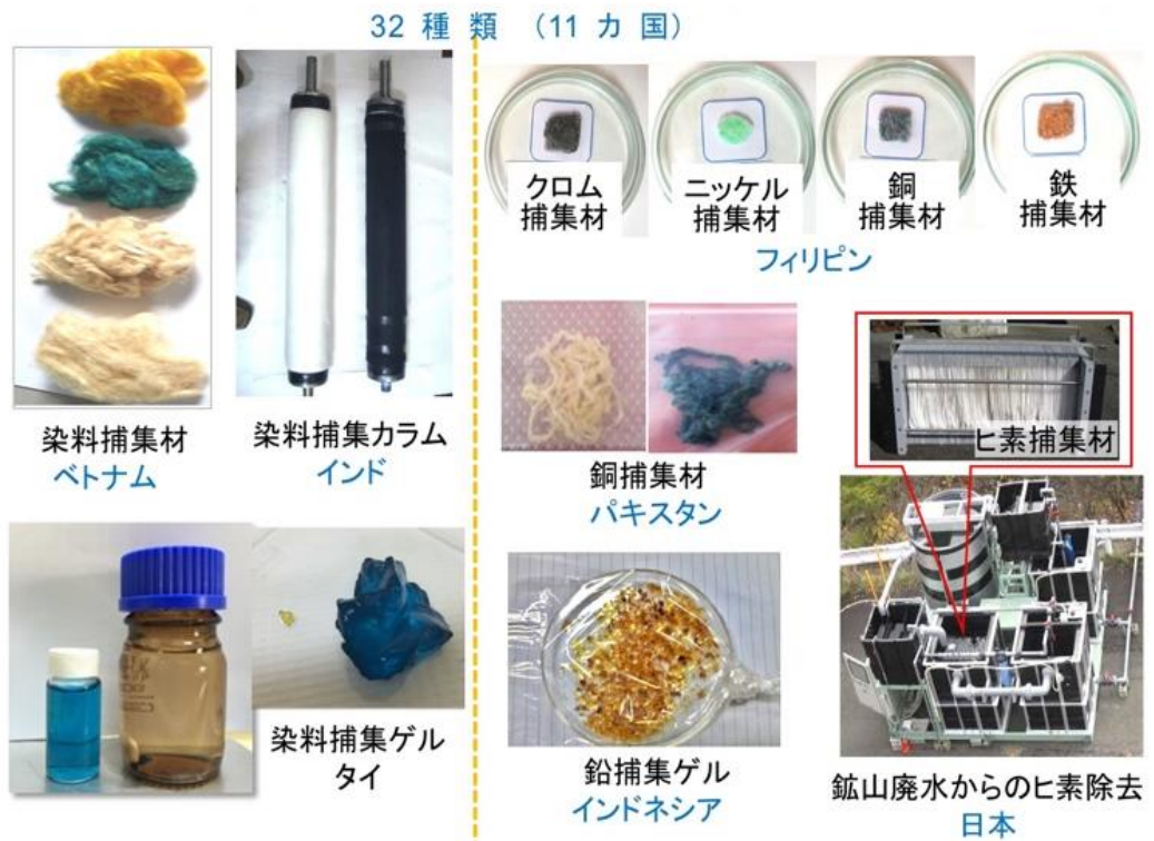
図7 放射線グラフト材料を用いた環境汚染軽減用捕集材
